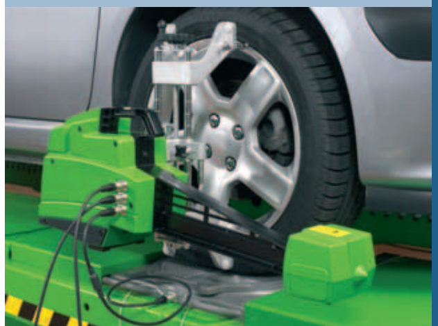
Sensores con cable y platos eléctricos
